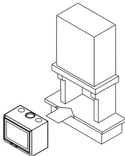
Los hogares empotrables van totalmente instalados dentro del hueco de la chimenea y no pueden ser retirados sin obras de demolición. Estos aparatos están disponibles tanto con cámara de convección y/o ventiladores como sin ellos. Los hogares empotrables suelen usarse en chimeneas de nueva construcción. Todos los trabajos de mantenimiento normales en el aparato podrán llevarse a cabo desde el interior, pero en alguna ocasión puede ser necesario tener que abrir un hueco de acceso en la camSartena.
