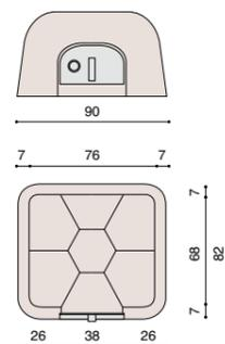
Forno realizzato in materiale refrattario ad alto contenuto di alumina, dotato di antina in metallo e termometro (il raccordo fumi, necessario per il funzionamento, va ordinato a parte).
